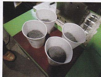
均一な混合ができれば、インシュレーター1個分の粉末素材を0.1gの精度で計量
