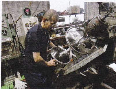
中華鍋のような混合機で8種の粉をまんべんなく混ぜ合わせる。金井社長が自作したもので、斜めにしているのは、洗濯機のように攪拌をスムーズに行うため
